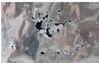
Perforations-/Lochbildung bei Normal- und Pulse-Mode
